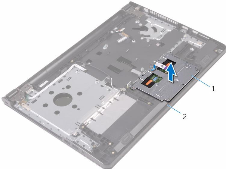
1 nosač podloge osjetljive na dodir
